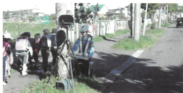
▲可搬式速度違反自動取締装置（いわゆる「可搬式オービス」） 県警察本部提供資料より
